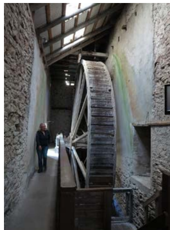
Vattenrännan leder fram vattnet till överfallshjulet. Foto: Pär Malmros.
